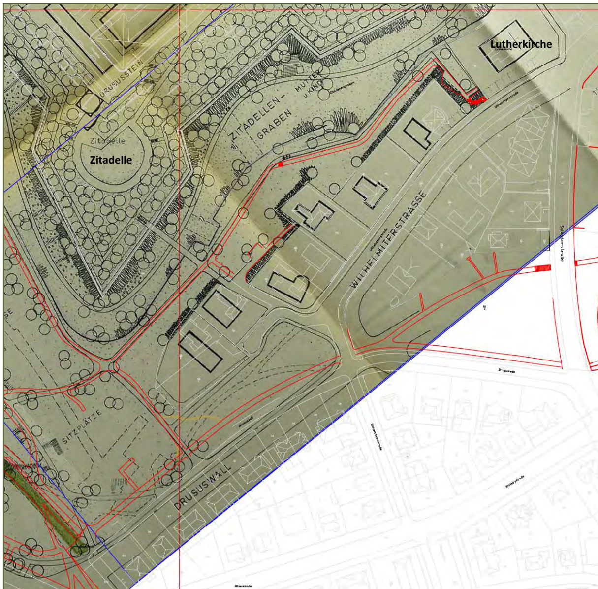
Abb. 62 Planüberlagerung: Entwurf 1962 (Ausschnitt) mit projektierte Wegführung zur Lutherkirche (grau) – Wegebestand 2017 (rot)
