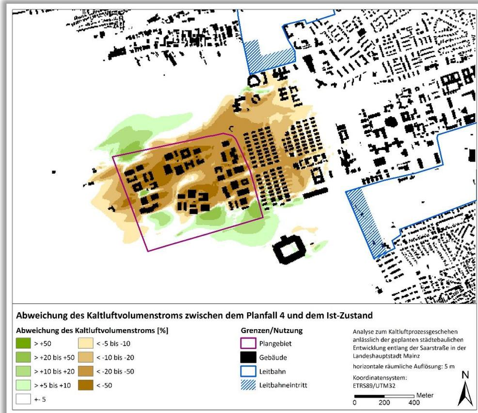
**Abb. 13: Abweichung des Kaltluftvolumenstroms zwischen dem Planfall 4 und dem Ist-Zustand.**
