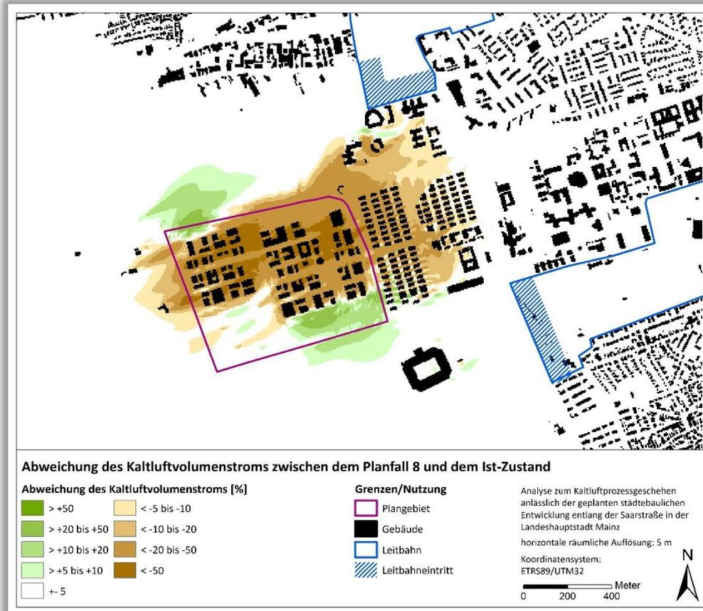
**Abb. 25: Abweichung des Kaltluftvolumenstroms zwischen dem Planfall 8 und dem Ist-Zustand.**
