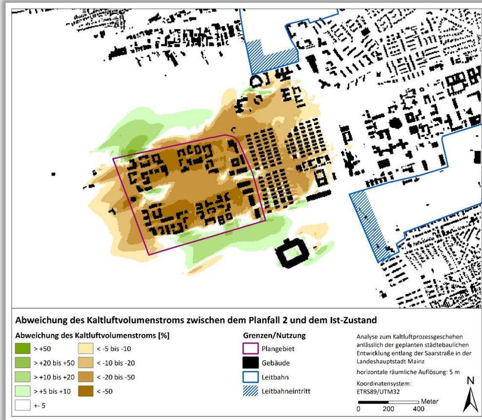
**Abb. 7: Abweichung des Kaltluftvolumenstroms zwischen dem Planfall 2 und dem Ist-Zustand.**
