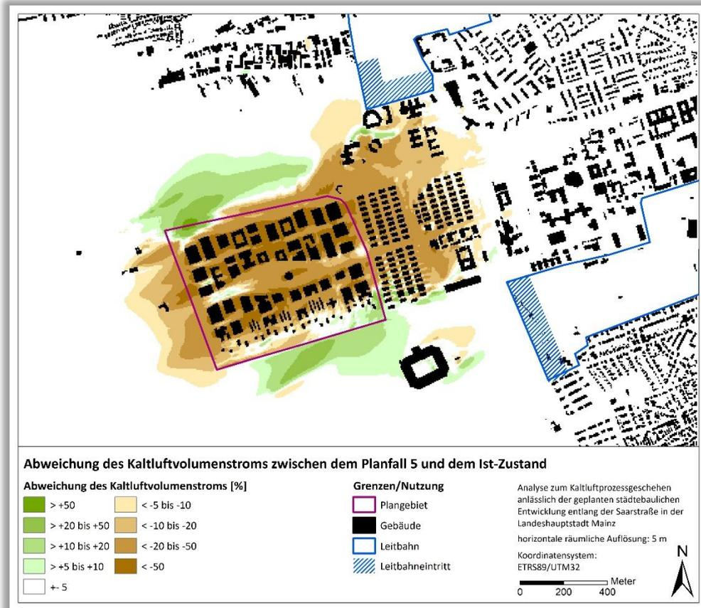
**Abb. 16: Abweichung des Kaltluftvolumenstroms zwischen dem Planfall 5 und dem Ist-Zustand.**
