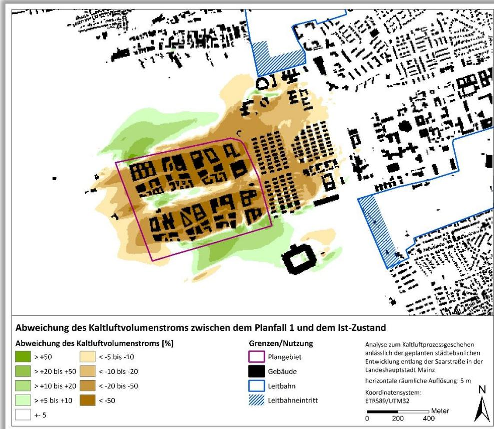
**Abb. 4: Abweichung des Kaltluftvolumenstroms zwischen dem Planfall 1 und dem Ist-Zustand.**
