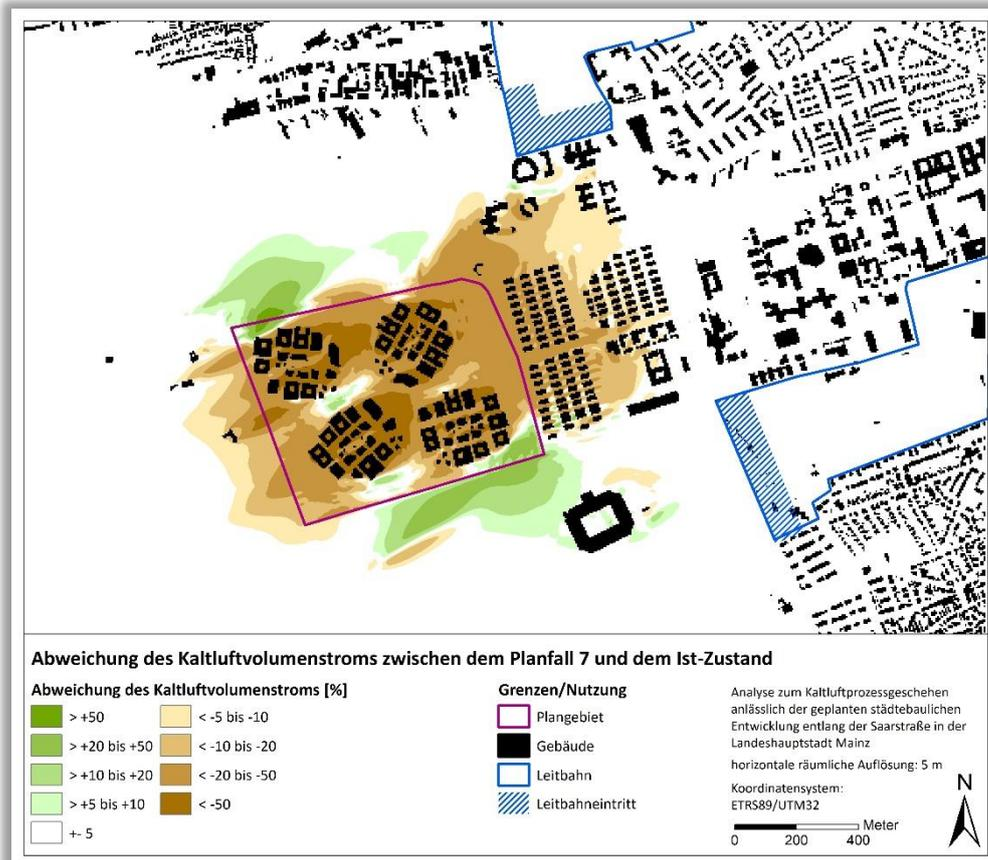
**Abb. 22: Abweichung des Kaltluftvolumenstroms zwischen dem Planfall 7 und dem Ist-Zustand.**
