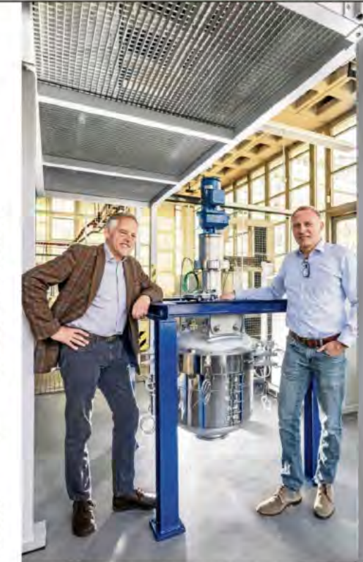
Professor Thomas Willner (l.) und Nexoil-Chef Thorsten Dunker mit einem Reaktor, der aus Abfällen CO 2 -freien Diesel herstellt. Zunächst werden Altfette in Kraftstoff umgewandelt.
